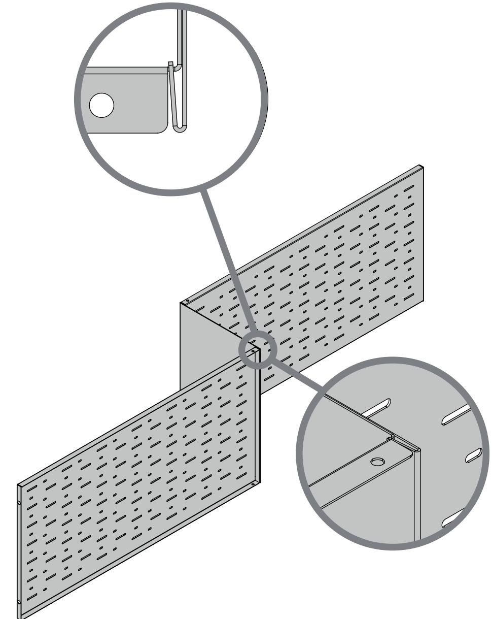
Montaje tercer nivel compartido, ancho 200 | Montage troisième niveau partagé, largeur 200 | Assembly shared third level, 200 wide
