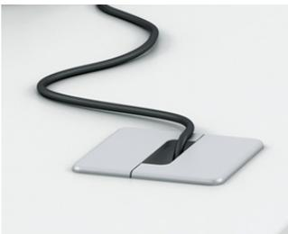
Composé de deux pièces injection plastique (ABS) faciles à monter. Le diamètre intérieur est de 80 mm, les dimensions extérieures sont de 94x94 mm. Dispose en son centre d'un creux pour le passage des câbles. Disponible pour différentes positions (voir tarif).
